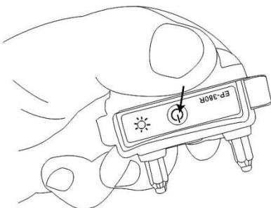
Zatlačte tlačítko 3x za sebou a príjmač sa zapne. O správnosti Vám to potvrdí zelená kontrolka.
