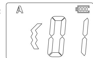
Znaczy to, że wybrana jest obroża A a wibracje są ustawione na stopień 1 (najniższy). Jest 10 stopni wibracji a 10 jest najsilniejszy. Dla wysłania sygnału wibracji naciś przycisk „T“ a obroża zawibruje.
