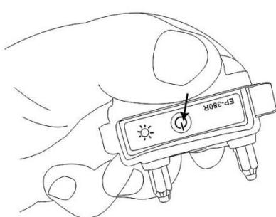
Zmáčkněte tlačítko 3x po sobě a přijímač se zapne.
