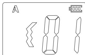
Znamená to, že je zvolen obojek A a vibrace je nastavena na stupeň 1 (nejnižší). Je zde 10 stupňů vibrací, 10 je nejsilnější. Pro vyslání signálu pro zavibrování zmáčkněte tlačítko „T“ a obojek zavibruje.
