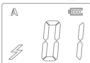
Znamená to, že je zvolen obojek A a impulz je nastaven na stupeň 1 (nejnižší). Je zde 99 stupňů impulzu, 99 je nejsilnější. Pro vyslání signálu pro impulz zmáčkněte tlačítko „T“ a obojek podá impulz. Pro ověření funkčnosti přiložte testovací výbojku, která je přiložena v balení, k elektrodám. Ta se po vyslání impulzu rozžehne.
