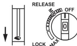
Nastavte pákové tlačítka do polohy LOCK a otočte ovládací knoflík proti směru hodinových ručiček.
