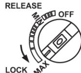
Otočením ovládacího knoflíku proti směru hodinových ručiček se ohříváč zapálí, a zapalovací kroužek vratě do původní polohy.
