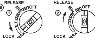
Po vyjmutí láhev zůstane v potrubí nějaký zbytkový plyn. Znovu zapalte stroj, a poté můžete vypnout ovládací knoflík.
