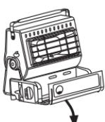
Pomocí dírky prstem otevřete kryt plynové kazety.
