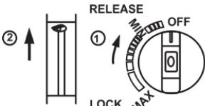
Abyste mohli vyjmout plynovou kazetu, otočte ovládací knoflík do polohy OFF a pákové tlačítko vratě do polohy RELEASE. Vyberte láhev.
