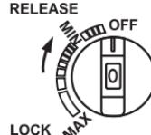
Otočením ovládacího knoflíku do polohy OFF přerušte přívod plynu.
