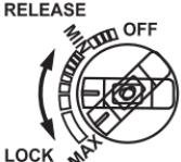
Otočením ovládacího knoflíku ve směru hodinových ručiček nastavte ohříváč na minimum a proti směru hodinových ručiček na maximum.
