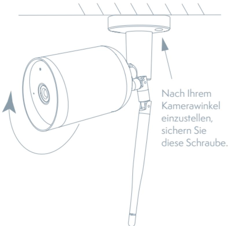
1. festigen der Kamera an der Wand mit den Schrauben
