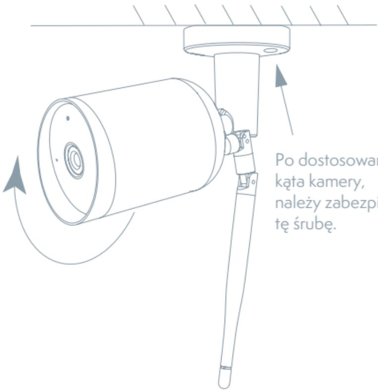
1. Przymocuj kamerę do ściany za pomocą śrub
