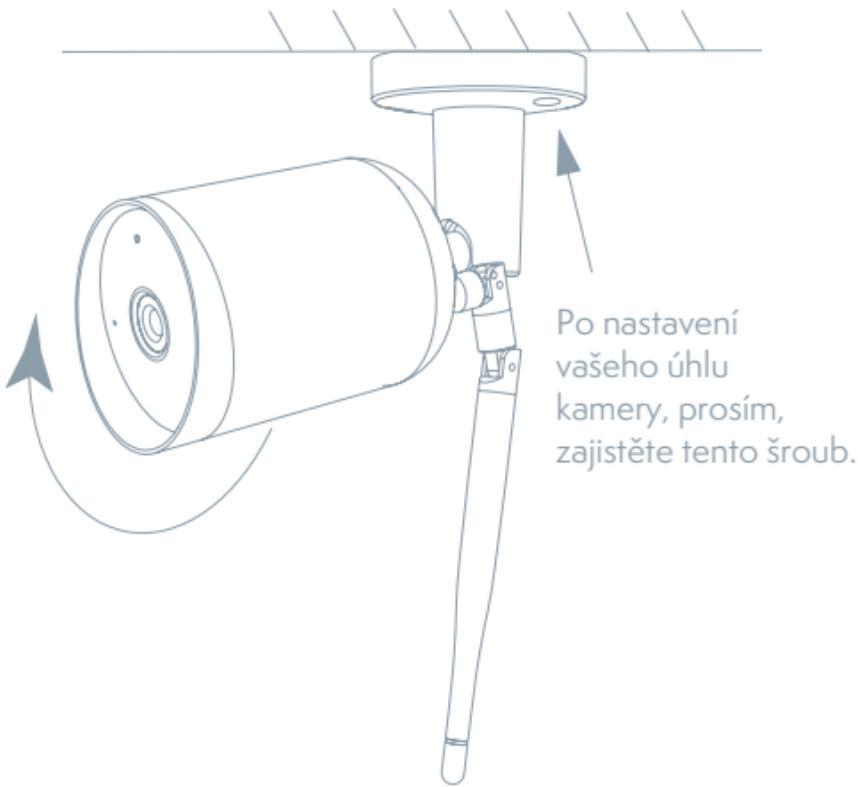
1. Připevněte kameru ke zdi pomocí šroubů
