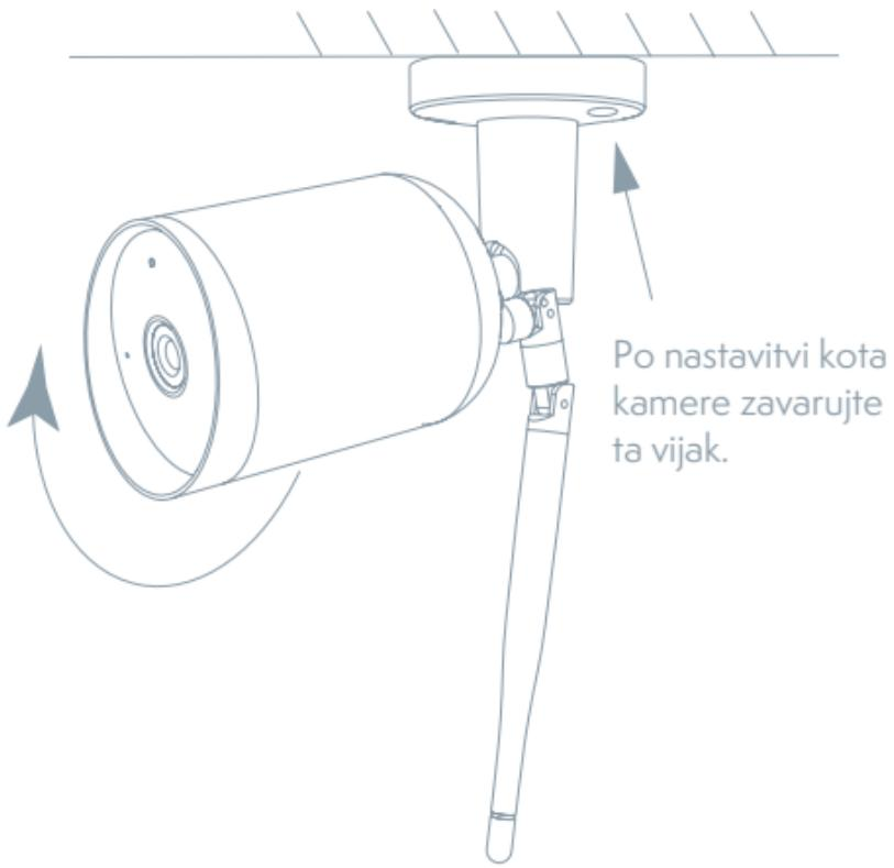
Po nastavitevi kota kamere zavarujte ta vijak.
