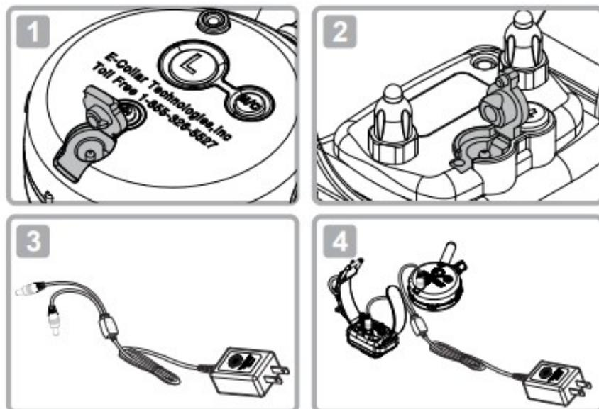
Während des Ladevorgangs leuchtet die Kontrollleuchte rot. Sobald das Gerät vollständig aufgeladen ist, wird es grün (ungefähr 2 Stunden).
