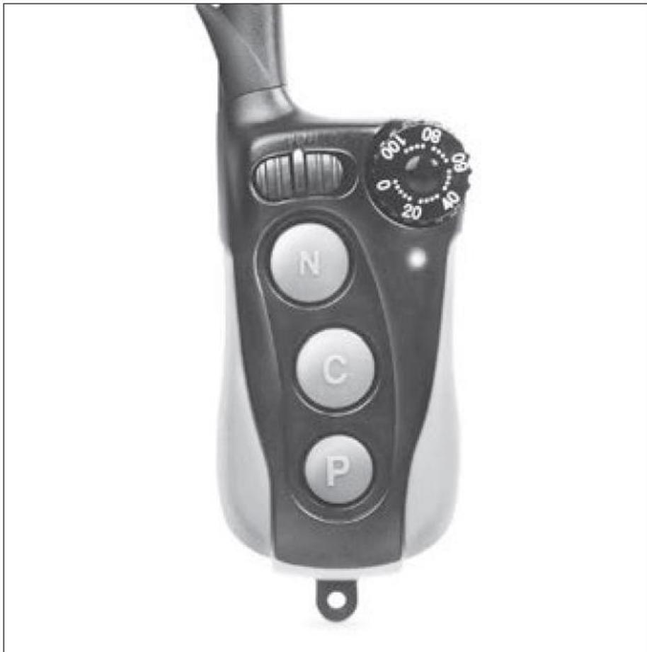
**При нажатии кнопки Nick** приемник излучает один быстрый импульс электрической стимуляции.
