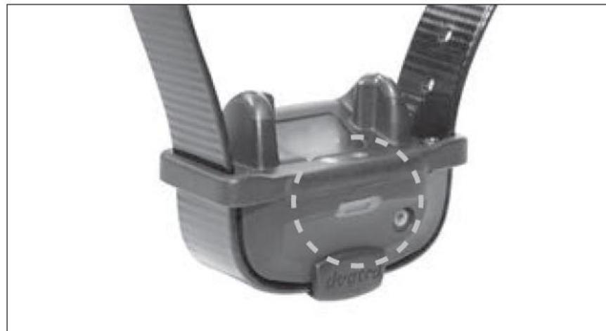
Светодиодный индикатор мигает каждые 4 секунды, когда приемник включен и готов к использованию. Светодиодный индикатор будет загорается как на передатчике, так и на приемнике, когда кнопки передатчика нажаты.
