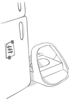
Un positionnement à proximité d'appareils en métal ou électroniques ne pose normalement aucun problème. Si un fonctionnement incorrect se produit, il peut être nécessaire d'éloigner le distributeur de ces appareils.
