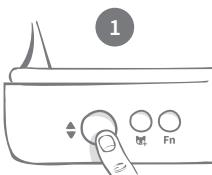
Appuyez sur le bouton d'ouverture/fermeture ( $\blacktriangleleft$ ) pour ouvrir le distributeur de nourriture.
