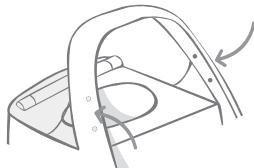
Il convient de l'essuyer avec un chiffon humide ou des lingettes pour nettoyage ménager. Veillez à maintenir les quatre points noirs sur l'arceau propres afin d'assurer un fonctionnement fiable.
