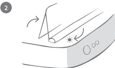
Het deksel wordt geopend en het lampje knippert elke seconde groen. De voerbak blijft in deze modus tot een huisdier wordt geprogrammeerd of tot u annuleert door nogmaals op de knop huisdier toevoegen (
