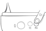
Drücken Sie die Taste für die Trainingsfunktion (**Fn**) erneut, damit sich die Abdeckung zunehmend bewegt. Die Abdeckung schließt sich ein wenig und die LED blinkt zweimal orange.
