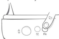
Commencez à augmenter les mouvements du couvercle en appuyant de nouveau sur le bouton Fonction d'Apprentissage (**Fn**). Le couvercle se ferme partiellement et le voyant orange clignote deux fois.
