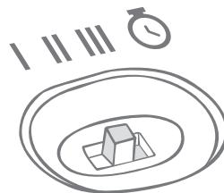
Standardmäßig steht der Schieberegler auf der mittleren Stufe (II), was einer Standardverzögerung entspricht.
