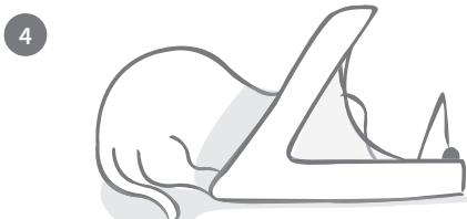
Wenn Ihr Haustier aus der Schale frisst und gespeichert wurde, hört die LED auf zu blinken und leuchtet konstant. Wenn das Tier sich vom Automaten entfernt, schließt die Abdeckung automatisch, und die grüne LED erlischt. Die Mikrochipnummer ist nun dauerhaft gespeichert, selbst wenn Sie die Batterien aus dem Gerät nehmen.
