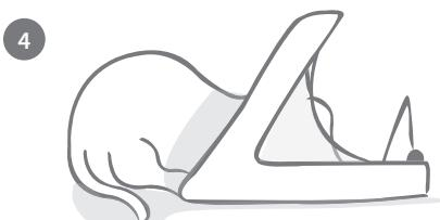
Wanneer uw huisdier uit het schaaltje eet en is geprogrammeerd, stopt het lampje met knipperen en blijft het branden. Wanneer uw huisdier wegloopt, gaat het deksel dicht en gaat het groene lampje uit. Zijn chipnummer is nu permanent opgeslagen in het geheugen, zelfs wanneer de batterijen worden verwijderd.
