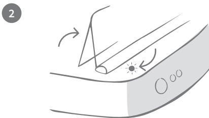
Die Abdeckung öffnet sich und die LED blinkt im Sekundentakt grün. Der Futterautomat bleibt in diesem Modus, bis das Tier gespeichert ist oder Sie ein zweites Mal auf die Taste zum Hinzufügen eines Tiers (
