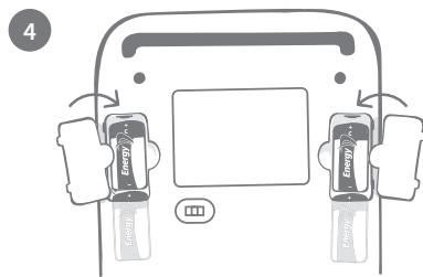
Setzen Sie die Batteriefachdeckel wieder ein.
