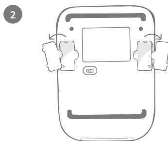
Levante la cubierta de las pilas.
