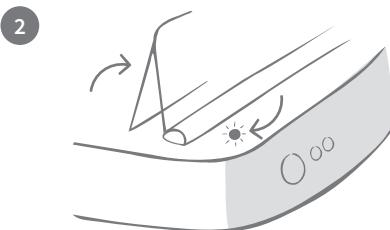
Låget åbnes, og indikatoren blinker grønt med et sekunds mellemrum. Foderautomaten forbliver i denne tilstand, indtil et kæledyr er registreret, eller du annulerer processen ved igen at trykke på knappen Tilføj kæledyr ( ).
