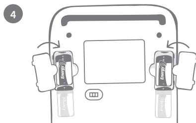
Vuelva a colocar la cubierta de las pilas.
