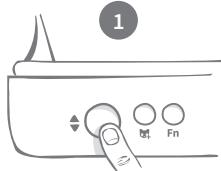
Drücken Sie die Taste zum Öffnen bzw. Schließen (◆), um den Futterautomaten zu öffnen.
