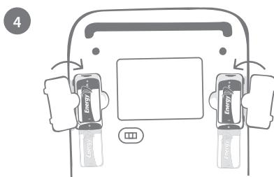
Remettez les couvercles des compartiments des piles en place.
