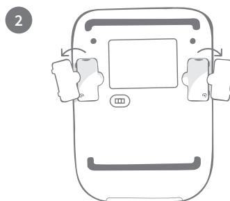
Entfernen Sie die Batteriefachdeckel.
