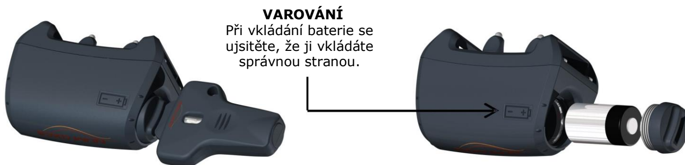
Diagram 4 Vložení baterie do CANICOM 5 přijímače
