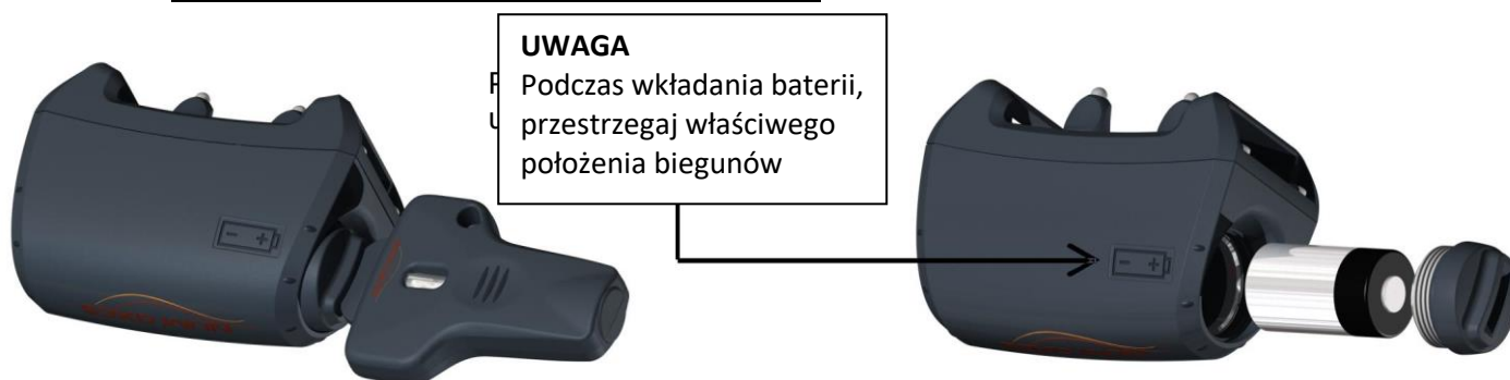
Diagram 4 Wkładanie baterii do odbiornika CANICOM 5
