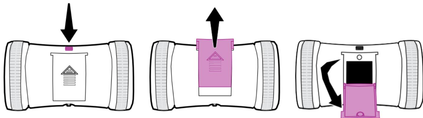
Um den Tank zu öffnen, drücken und halten Sie die Verriegelung neben der Tanktür, schieben Sie dann die Tanktür in Richtung der Verriegelung und öffnen Sie sie
