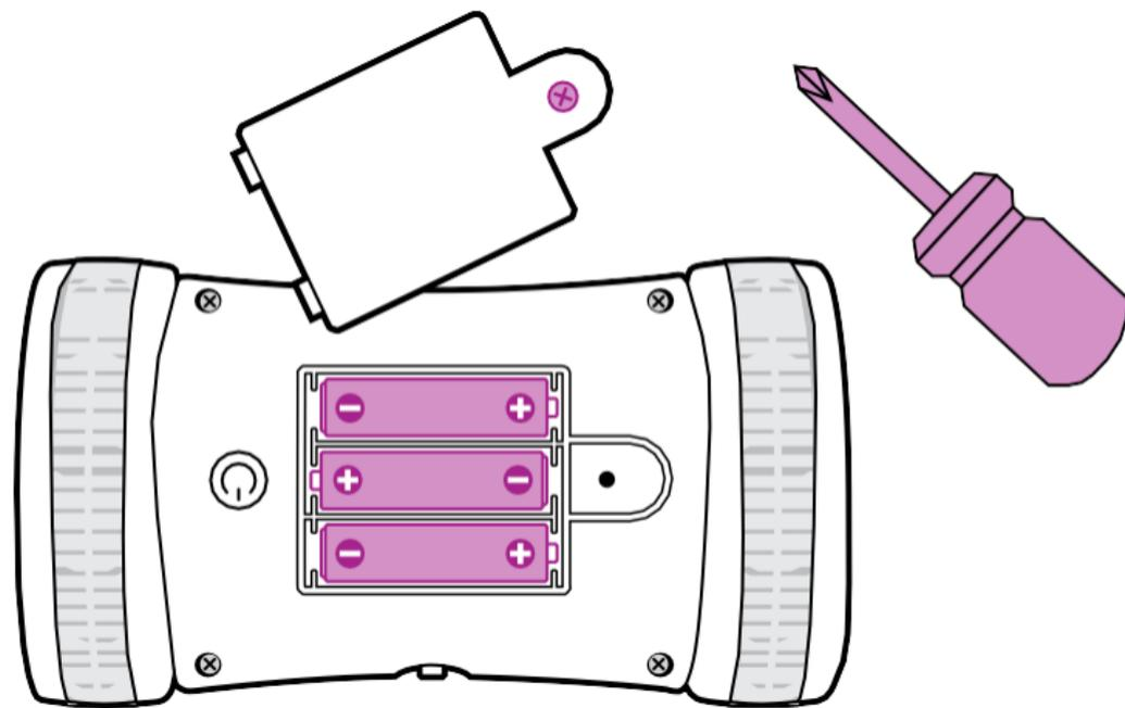
Lösen Sie mit einem Schraubendreher die Schraube, mit der das Batteriefach befestigt ist, und ziehen Sie dann die Lasche nach oben, um das Batteriefach zu entfernen. Legen Sie drei AA-Alkalibatterien in das Batteriefach ein. Bringen Sie das Batteriefach wieder an und ziehen Sie die Schraube fest, um es zu sichern
