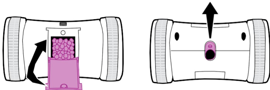
Füllen Sie den Tank mit bis zu 118 ml Trockenfutter, schließen Sie dann die Tankklappe und vergewissern Sie sich, dass sie einrastet. Öffnen Sie das Leckerchenausgabefenster und passen Sie es an die Größe des verwendeten Futters an
