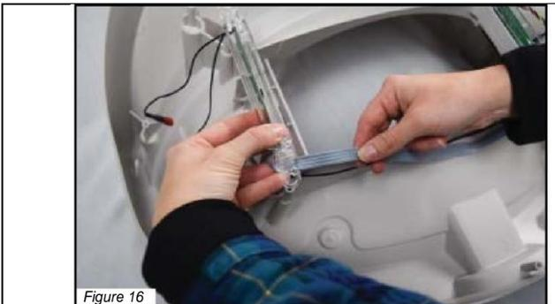
18. Schrauben Sie die 4 Schrauben ein, mit denen die beiden Halterungen an der Basis befestigt sind.
