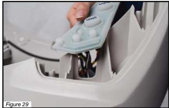
31. Bringen Sie die Blende wieder über der Platine und der Tastatur an. Halten Sie die Platine senkrecht und legen Sie den Rahmen darüber, so dass die Tasten durch das Bedienfeld gehen. Stellen Sie sicher, dass die Tastatur um die Kanten der Platine gewickelt ist.
