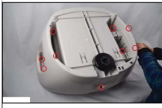
24. Drehen Sie die Basis mit der rechten Seite nach oben und schrauben Sie die Blende ab. Heben Sie es auf, drücken Sie die Knöpfe, um es zu lösen, und legen Sie es beiseite. Siehe Seite 1 für detaillierte Anweisungen.
