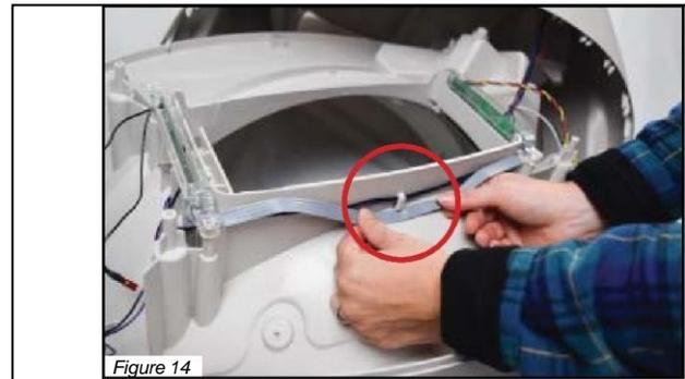
16. Heben Sie die Halterungen der DFI-Platine von der Basis ab.
