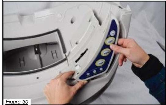
32. Stellen Sie sicher, dass die Kanten des Rahmens bündig mit der Basis sind. Sobald es an seinem Platz ist, schauen Sie durch das Loch, wo das schwarze Zahnrad herausragt, und stellen Sie sicher, dass keine Drähte sichtbar sind. Wenn die Drähte sichtbar sind, entfernen Sie den Rahmen, führen Sie sie in den Drahtkanal ein und sichern Sie sie mit einem Stück Klebeband
