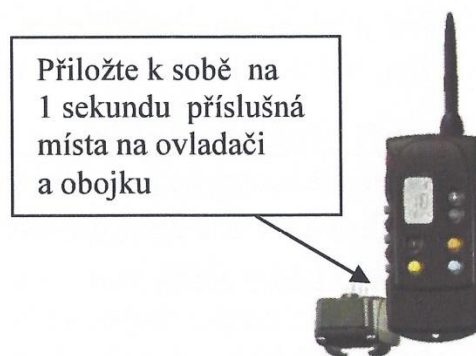
Obr.7 – Zapnutí/vypnutí obojku ovladačem CANICOM 1500
