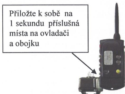
Obr.6 – Zapnutí/vypnutí obojku ovladačem CANICOM 800
