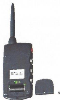
Obr.8 – Výměna baterie u ovladače CANICOM 800
