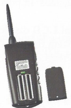
Obr.9 – Výměna baterií u ovladače CANICOM 1500
