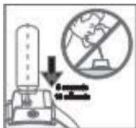
Empfängt der Empfänger 5 Minuten lang kein Fernbedienungssignal, geht er automatisch in den Schlafmodus. Um es neu zu starten, halten Sie entweder die Sprühtaste oder die Summertaste auf der Fernbedienung 3 Sekunden lang gedrückt.
