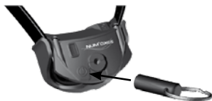
Fig. 5 Accensione e spegnimento del collare con la chiave magnetica
