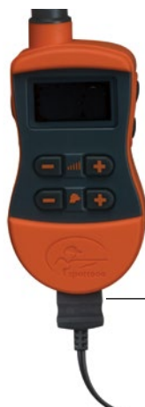
NABÍJECÍ KONEKTOR PŘIPOJENÝ DO OTVORU PRO NABÍJEČKU
