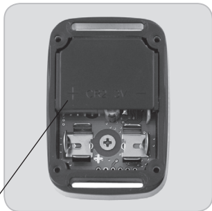
Markierung der Batteriepolartität
