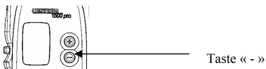
2) Wenn Sie die Stufe « 01 » erreichen, dann drücken Sie 5 Sek. lang die Taste « - »: « 00 » blinkt auf dem LCD-Bildschirm
