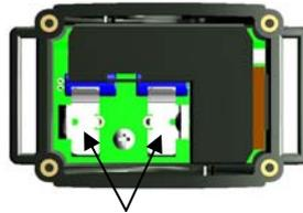
**Reset:** Verbinden Sie die beiden Batteriepole mit einem metallischen Gegenstand
