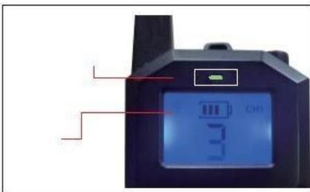
Wenn sich der Sender in einem Niederspannungszustand befindet, blinkt die Anzeigeleuchte alle 10 Sekunden fünfmal hintereinander und der Batteriestatus wird auf dem Bildschirm angezeigt. Die rote Anzeige blinkt während des Ladevorgangs, die grüne Anzeige blinkt einmal alle 10 Sekunden nach dem vollständigen Aufladen.
