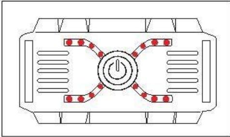
Wenn sich der Empfänger in einem Niederspannungszustand befindet, blinkt das rote Licht fünfmal alle zehn Sekunden
