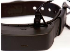
**Mit der Lithium-Ionen-Technologie benötigt das GPS Halsband nur 2 Stunden zum Aufladen. Es schadet dem Gerät nicht, wenn es länger als 2 Stunden geladen wird.**
