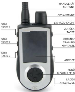
**HANDGERÄT:** Empfängt Standortaktualisierungen vom GPS Halsband und zeigt diese an. Das Gerät ist wasserdicht und kann bis zu einer Tiefe von 1,5 m in Wasser getaucht werden.
