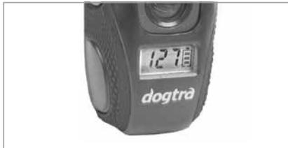
Um die Hintergrundbeleuchtung des LCD-Bildschirms ein-/ auszuschalten, drücken Sie kurz auf den Ein-/ Ausschaltknopf. Der LCD-Bildschirm zeigt die Impulsstufe (0 - 127) an. Die Balkenanzeige zeigt bei voller Akkuladung 3 Balken an, bei halber Ladung 2 Balken und einen Balken, wenn das Gerät geladen werden muss. Die Balkenanzeige zeigt nur den Ladestatus des Senderakkus an. Der Ladestatus des Empfängerakkus kann durch die Farbe der LED-Anzeige des Empfängers überprüft werden
