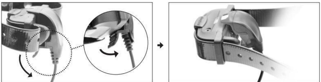
3. Ziehen Sie an der Lasche an der Unterseite des Ladegeräts und entfernen Sie es vom Empfänger.
