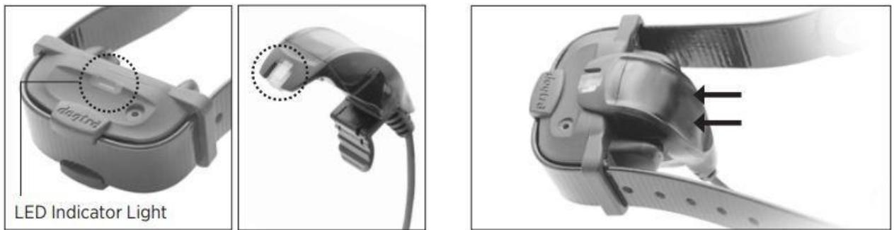
1. Richten Sie das Kunststoffteil des Ladegeräts mit der LED des Empfängers aus.
