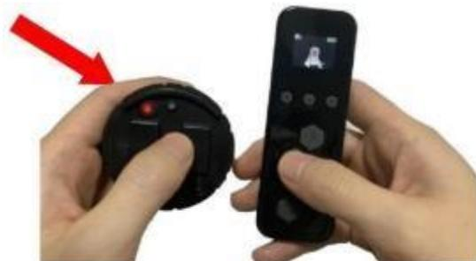
3. Drücken Sie eine beliebige Taste auf dem Sender. Sie hören erneut einen Piepton, was bedeutet, dass der Empfänger mit dem Sender gekoppelt wurde.
