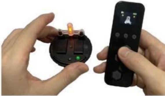
4. Wenn der Empfänger funktioniert, wird er nach 2 Minuten in den Ruhezustand versetzt. Drücken Sie eine beliebige Taste auf der Fernbedienung, um ihn wieder zu aktivieren.
