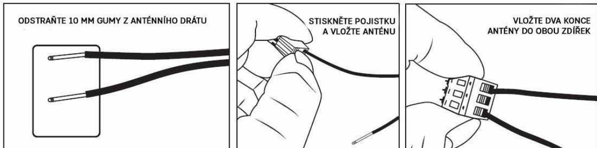
Entfernen Sie 10 mm des Gummis vom Antennendraht
