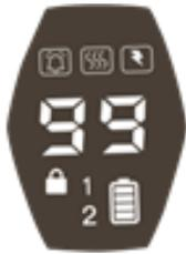
**LED-Display** : Anzeige von Puls, Warnton oder Vibrationsmodus, Anzeige der Pulsstufe, Sperren oder Entsperrern der Pulsstufe, Auswahl des Hundes, Batteriestand.
