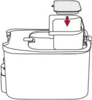
⑥ Füllen Sie das Wasser im Wassertank bis zur MAX-Linie auf.
