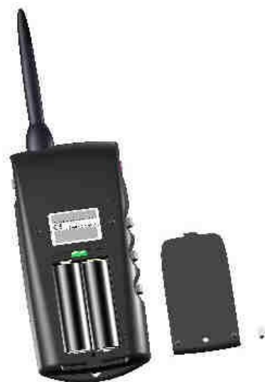
Wykres 13 Wymiana baterii w pilocie zdalnego sterowania CANICOM 1500 PRO
