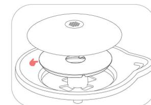
③ Setzen Sie den Filter in den Tank ein und bringen Sie die obere Abdeckung an.
