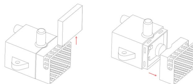
① Entfernen Sie den Pumpenschwamm ② Drücken Sie auf beide Seiten der Saugplatte und ziehen Sie sie heraus
