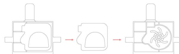
③ Entfernen Sie die Kappe ④ Heben Sie das Drehrad an und reinigen Sie es
