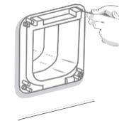
Setzen Sie die Katzenklappe mit dem verlängerten Tunnel wieder in die Öffnung ein. Schrauben Sie mit den zu den Dübeln passenden Schrauben die Katzenklappe an die Wand an. **Siehe dazu das Diagramm.**
