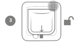
Der Riegel öffnet sich, um Ihre Katze durch die Klappe gehen zu lassen, und die Anzeileuchte blinkt einmal pro Sekunde. Jetzt ist die Katzenklappe im Modus „Tier hinzufügen“.
