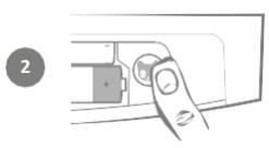
Entfernen Sie die Batteriefachabdeckung, um die Taste „Tier hinzufügen“ freizulegen und drücken Sie diese für 1 Sekunde, um in den Modus „Tier hinzufügen“ überzugehen.
