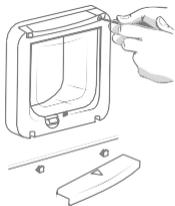
Die Katzenklappe kann direkt an Ihrer Innenwand fixiert werden. Um auf die erforderlichen Schraubenbohrungen zuzugreifen, müssen Sie den Frontrahmen vom Tunnel lösen. Dazu entfernen Sie die Batteriefachabdeckung und die Schraubenabdeckkappen. Danach lösen Sie die vier innen liegenden Schrauben und trennen den Tunnel und Frontrahmen voneinander.
