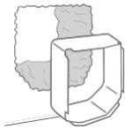
Prüfen Sie anhand einer der Tunnelverlängerungen, ob die Bohrung durch die Wand wirklich frei ist. Wenn das der Fall ist, entfernen Sie Schutt und Staub aus der Öffnung.
