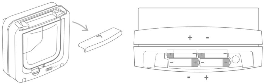
Um die Batterien einzulegen, nehmen Sie die Batteriefachabdeckung an der Vorderseite der Katzenklappe ab.
