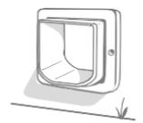
**8** Nehmen Sie den äußeren Rahmen wieder ab und prüfen Sie, dass alle Markierungen deutlich sichtbar sind. Bohren Sie dann mit einem 6 mm (1/4") Bohreinsatz die zwei Löcher für die Schrauben und achten Sie darauf, dass Sie in horizontaler Ausrichtung bohren. Wir empfehlen, als Nächstes die richtige Schraubenlänge zu bestimmen. Dies erklären wir im folgenden Schritt.
