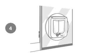
Vom Inneren des Hauses aus führen Sie den Tunnel durch die Öffnung im Glas und stellen dabei sicher, dass die Katzenklappe innerhalb des Lochs mittig positioniert ist. Drücken Sie sowohl die Katzenklappe als auch den Montageadapter fest an, sodass das Dichtungsmittel gegen die Glasscheibe gedrückt wird. Denken Sie daran, dass sich die Seite mit dem SureFlap Logo im Inneren des Hauses befinden muss.
