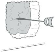
Entfernen Sie das Material dazwischen mit einem geeigneten Werkzeug. **Wir empfehlen, die Bohrung durch die Wand nicht in einem einzigen Schritt zu schneiden.** Entfernen Sie zunächst das Material an der Innenwand; anschließend gehen Sie nach draußen, um den Rest von der Außenseite des Hauses aus zu beseitigen. **Das Loch sollte innerhalb des markierten Bereichs bleiben, sonst wird es zu groß.**
