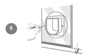
Danach schieben Sie den äußeren Rahmen über den Tunnel. Mit einem Kreuzschlitzschraubenzieher und den zuvor ausgewählten Schrauben befestigen Sie den äußeren Rahmen in seiner Position. Ziehen Sie die erste Schraube leicht an (noch nicht ganz fest) und tun Sie dasselbe mit der zweiten Schraube. Nachdem Sie beide Schrauben angezogen haben, ziehen Sie sie vollständig fest.
