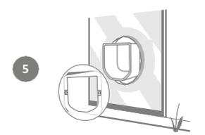
An der Außenseite des Hauses schieben Sie den zweiten Montageadapter über den Tunnel, wobei das Dichtungsmittel zum Fenster zeigt. Die Person, die sich im Haus befindet, sollte dabei weiterhin gegen die Katzenklappe drücken, sodass diese nicht verrutschen kann.
