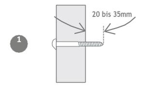
Um aus den mitgelieferten Schrauben die Schrauben mit der korrekten Länge zu wählen, vergleichen Sie die Schraubenlänge mit der Stärke Ihrer Tür. Die Schrauben sollten zwischen 20 und 35 mm (25/32 bis 2 3/8") länger sein, als das Glas dick ist.
