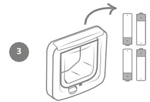
3 Entfernen Sie die Batterien und setzen Sie die Batteriefachabdeckung wieder auf. Der Riegel bleibt entsperrt, sodass Sie die Katzenklappe jetzt als gewöhnliche Katzenklappe verwenden können.
