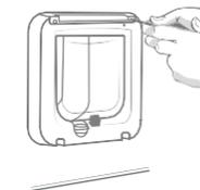
Schrauben Sie den Frontrahmen wieder auf das Tunnelende. Es ist wichtig, dass diese Teile korrekt miteinander verbunden werden. Bitte stellen Sie sicher, dass die Spalte zwischen den Teilen nicht breiter ist als die Dicke einer Kreditkarte. Sobald die Teile miteinander verschraubt sind, setzen Sie die Batteriefachabdeckung sowie die inneren Schraubenabdeckkappen wieder auf Ihre Katzenklappe auf.
