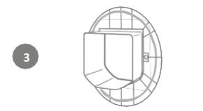
Setzen Sie einen Montageadapter (egal welchen) auf den Tunnel der Katzenklappe, sodass die Seite mit dem Dichtungsmittel nach außen zeigt und mit keinen Oberflächen in Berührung kommt.
