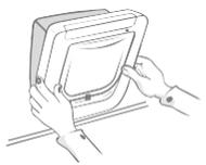
**7** Stellen Sie an der Außenseite des Hauses sicher, dass der Tunnel der Katzenklappe sicher durch die Öffnung geschoben wird. Stecken Sie dann den Außenrahmen auf den Tunnel. Ist der Rahmen korrekt ausgerichtet, markieren Sie die Position der Schraubenlöcher mit einem gut gespitzten Bleistift.
