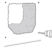
Entfernen Sie die Klappe von der Wand und legen Sie sie abseits des Arbeitsbereichs ab. Bohren Sie die vier Löcher mit dem entsprechenden Bohrer und achten Sie darauf, nicht die Ränder der Hauptöffnung zu durchbrechen. Schieben Sie anschließend einen Dübel in jedes gebohrte Loch.
