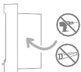
**Nicht in den Tunnel der Katzenklappe schneiden oder bohren.**
