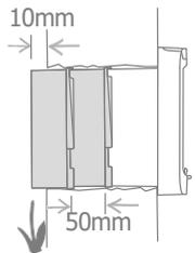
Damit der Tunnel der Katzenklappe bis zur Außenseite der Wand reicht, müssen Sie diesen mit den **Tunnelverlängerungen** erweitern. Der Tunnel der Katzenklappe ist 70 mm (2 15/16") lang, während jede Verlängerung weitere 50 mm (2") hinzufügt. Sie müssen also berechnen, wie viele Verlängerungen Sie benötigen, bis der Tunnel die Außenseite erreicht. **Das Tunnelende muss an der Außenseite mindestens 10 mm (3/8") hervorstehen, damit der äußere Rahmen aufgesetzt werden kann.**
