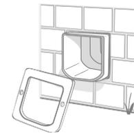
Gehen Sie jetzt nach draußen zur Außenwand. Der verlängerte Tunnel sollte nun aus dem Loch herausragen. Schieben Sie den Außenrahmen über den Tunnel.
