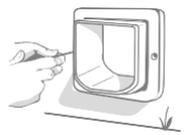
**11** Setzen Sie jetzt die beiden Abdeckkappen auf die Schrauben am äußeren Rahmen.
