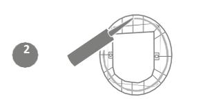
Wir empfehlen, bei der Montage in Glas zu zweit zu arbeiten; eine Person im Haus und eine Person außerhalb. Tragen Sie zunächst einen Streifen transparenten, wetterfesten Dichtungsmittels auf der Rückseite beider Montageadapter, etwa 15 mm (9/16") vom Rand entfernt, auf. Stellen Sie sicher, dass Ihre Katzenklappe griffbereit liegt und bereit zur Montage ist.
