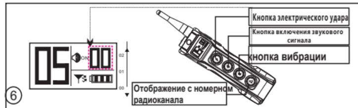
**Пятый шаг:** Сопоставьте выпуклый овал на корпусе передатчика с вогнутым овалом на приёмнике до тех пор, пока приёмник не провибрирует. Непрерывно светящийся красный светодиод информирует о том, что приемник включен.
