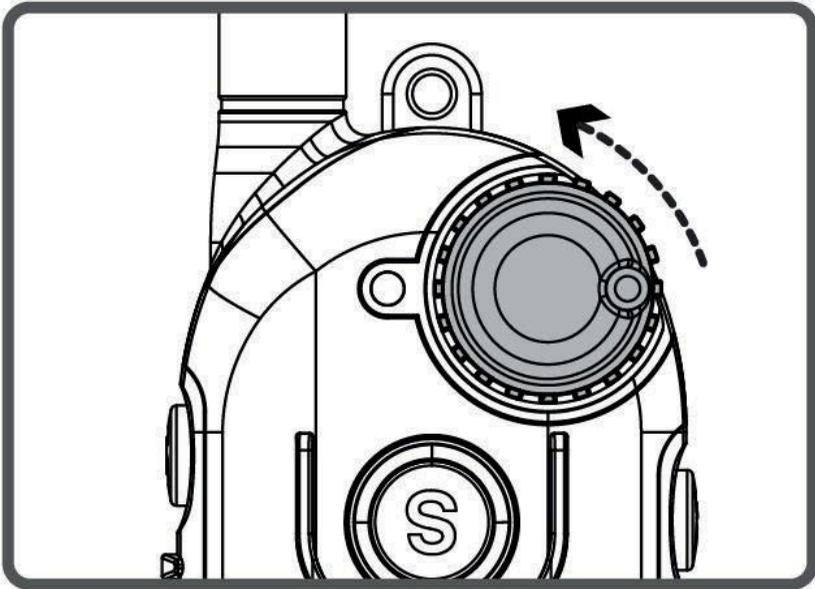
Drehen Sie den Stärkereglern entgegen dem Uhrzeigersinn, erhöhen Sie damit die Impulsstufe.
