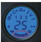
Halsbandempfänger: Blinkt bei eingeschaltetem Empfänger das Halsband rot, muss der Akku geladen werden. Wir empfehlen ein vorsorgliches Laden nach 30 Stunden Einsatz
