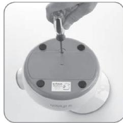
Verwenden Sie einen handelsüblichen Kreuzschlitzschraubendreher, um an das Batteriefach zu gelangen.
