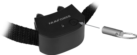
Fig. 6 Puesta en/fuera de servicio del collar receptor con la llave magnética
