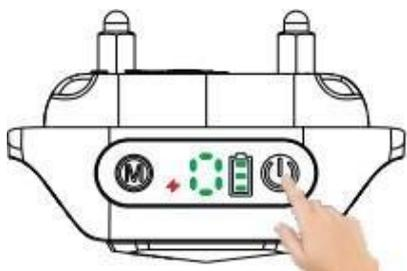
Drücken Sie den Netzschalter, um in den Testmodus zu wechseln, und vergewissern Sie sich vor dem Testen, dass die Ziffer 0 anzeigt.
