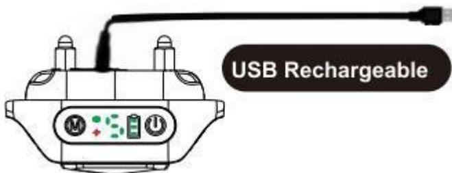
Sie können das Produkt über einen Computer, eine Powerbank oder einen Adapter mit einer Ausgangsspannung von 5 V für 2-3 Stunden aufladen.
