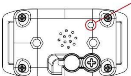
Simulieren Sie das Bellen in Richtung des Mikrofonsensors.
