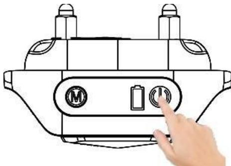
Schalten Sie das Gerät ein, indem Sie den Netzschalter 2 Sekunden lang gedrückt halten.
