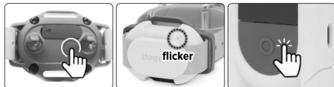
2. Schalten Sie den zu koppelnden Empfänger aus, und halten Sie dann seinen Ein-/Ausschaltknopf 6 Sekunden lang gedrückt, bis die LED-Anzeige beginnt, schnell zu blinken.
