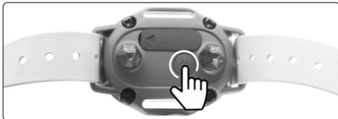
Der Ein-/Ausschaltknopf des Empfängers befindet sich zwischen den beiden Kontakten. **Halten Sie den Knopf drei Sekunden lang gedrückt, um den Empfänger ein- oder auszuschalten.** Leuchtet beim Einschalten die grüne LED-Anzeige auf, dann funktioniert der Empfänger normal.
