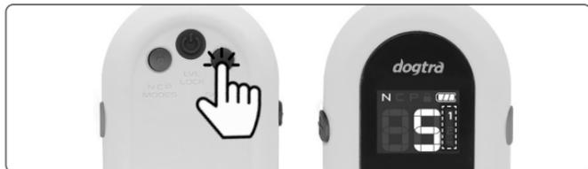
Falls Sie zusätzliche Empfänger erwerben, können Sie den Empfänger, der stimuliert werden soll, mit der Taste 'Dog Select' anwählen. Der jeweils angewählte Hund wird am Bildschirm angezeigt, und die für den jeweiligen Hund eingestellte Impulsstufe wird vom Sender gespeichert.
