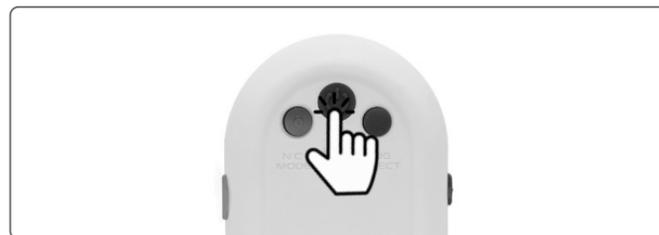
Nachdem Sie die gewünschte Impulsstufe eingestellt haben, können Sie durch einen kurzen Druck auf den Ein-/Ausschaltknopf die Impulsstufe verriegeln.
