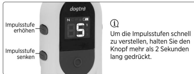
Der Hauptfunktionsknopf löst Impulse auf der aktuell gewählten Stufe aus, welche als Basis für den Booster dient.
