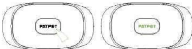
Halten Sie die Fernbedienungstasten Ton + Vibration gleichzeitig gedrückt, um das Empfängerhalsband zu koppeln.
