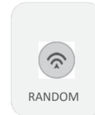
Drücken Sie im eingeschalteten Zustand kurz die Taste „RANDOM“, die obere Kontrollleuchte bleibt an und das Gerät schaltet in den multidirektionalen Modus. In diesem Modus wirft das Gerät den Ball zufällig in drei verschiedene Richtungen.
