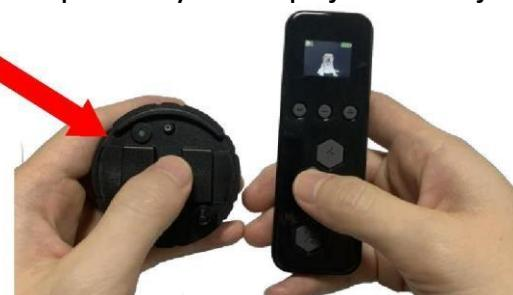
2. Znovu stiskněte tlačítko pro vypnutí a zapnutí na přijímači, rozsvítí se červená kontrolka a uslyšíte pípnutí
