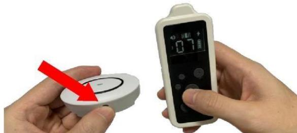
4. Pokud přijímač funguje přejde po 2 minutách do režimu spánku. Stisknutím libovolného tlačítka na dálkovém ovladači znova aktivujete.
