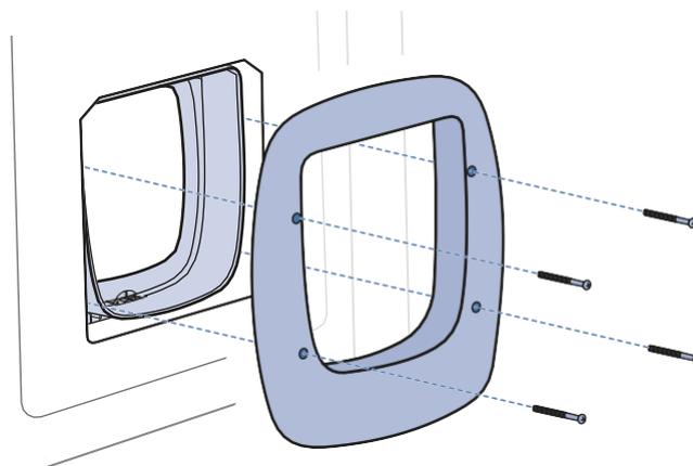
Platzieren Sie den Außenrahmen auf die Außenseite der Tür über den Tunnel des Innenrahmens.
