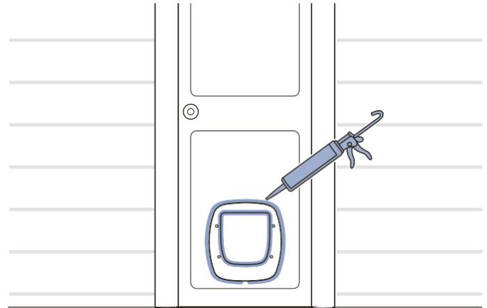
Wenn Sie die Katzenklappe in eine Außentür eingebaut haben, sollten Sie die folgenden Bereiche mit einer für den Außenbereich geeigneten Dichtungsmasse abdichten:
