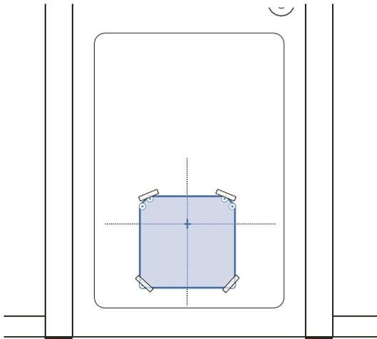
Schneiden Sie die Schneideschablone aus und befestigen Sie sie mit Klebeband an der Innenseite der Tür. Richten Sie Schulter- und Mittellinie der Schneideschablone an den zuvor auf der Tür angezeichneten horizontalen und vertikalen Linien aus.
