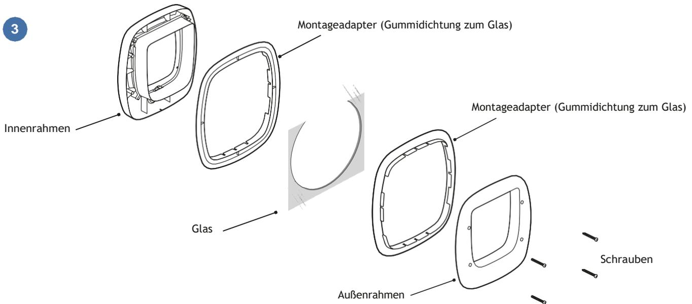
So bauen Sie die Katzenklappe in die ausgeschnittene Öffnung ein:
