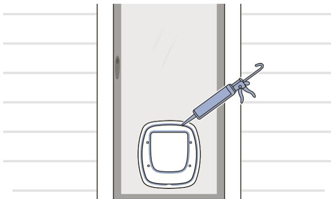
Wenn Sie die Katzenklappe in eine Außentür oder ein Fenster eingebaut haben, dichten Sie die folgenden Bereiche mit einer für den Außenbereich geeigneten Dichtungsmasse ab:
