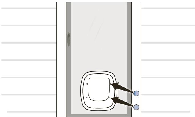
Prüfen Sie nach dem Festziehen der Schrauben erneut, ob die Katzenklappe waagrecht in die Öffnung eingebaut wurde.
