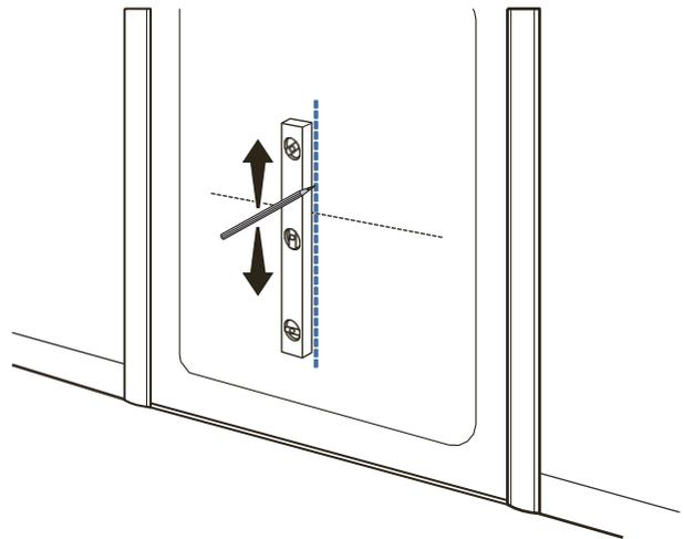
Zeichnen Sie mit einem Bleistift eine senkrechte Linie entlang der Stelle, an der sich die Mitte der Katzenklappe befinden soll. Wenn Ihre Tür Einsätze besitzt, sollten Sie überlegen, wie Sie die Katzenklappe am besten platzieren, um Lücken zwischen dem Katzenklappenrahmen und der Tür zu vermeiden.
