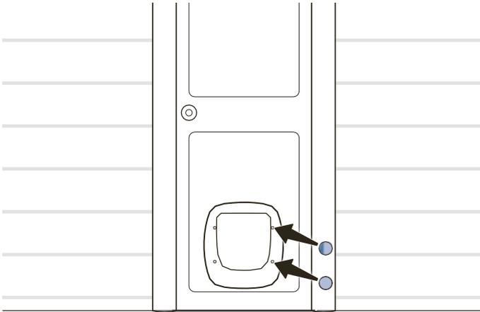
Prüfen Sie nach dem Festziehen der Schrauben erneut, ob die Katzenklappe waagrecht in die Öffnung eingebaut wurde.
