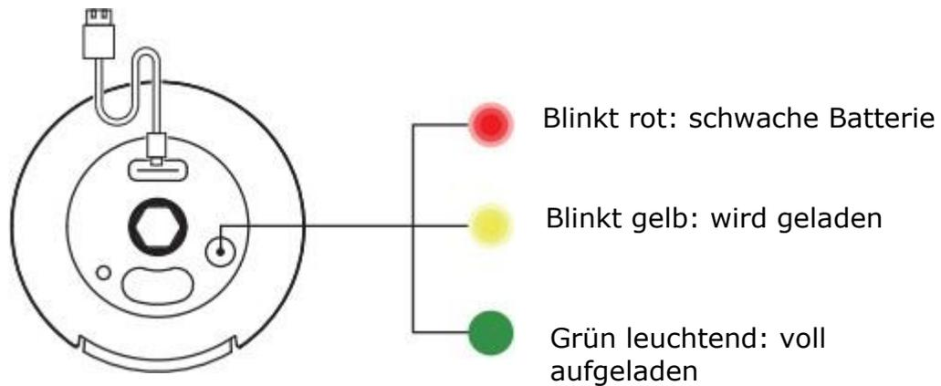
Reinigen Sie vor dem Aufladen den Ladeanschluss und halten Sie ihn trocken. Wenn der Wicked Ball Air eine der folgenden Bedingungen aufweist, ist der Akku schwach und muss aufgeladen werden: 1. Die Anzeigeleuchte blinkt beim Einschalten rot und schaltet sich dann automatisch aus. 2. Er reagiert nicht auf langes Drücken der Funktionstaste.
