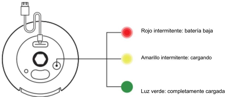
Limpie el puerto de carga y manténgalo seco antes de cargarlo. Si Wicked Ball Air muestra alguna de las siguientes condiciones, indica que la batería está baja y necesita cargarse: 1. La luz indicadora parpadea en rojo después del encendido y luego se apaga automáticamente. 2. No responde al presionar prolongadamente el botón de función.
