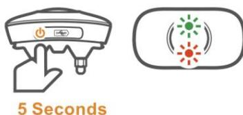
1. Control del receptor: cuando el dispositivo esté apagado, presione el botón de encendido durante 5 segundos para ingresar al modo de emparejamiento, la pantalla parpadeará en verde y rojo.
