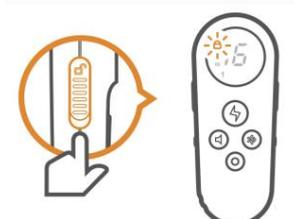
**Verificar la conexión del perro:** seleccione un canal y luego presione el botón de rueda. El receptor correspondiente parpadea en blanco.
