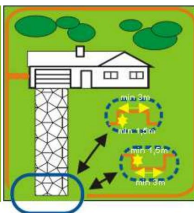
A teljes kert bekerítése a bejárat kapu kivételével. Ezekben helyenként a vezeték kihozzák a kapu fölé, vagy a földbe temetik, és így a vevőgallér kikerül a kisugárzott jel útjából. huzal.
