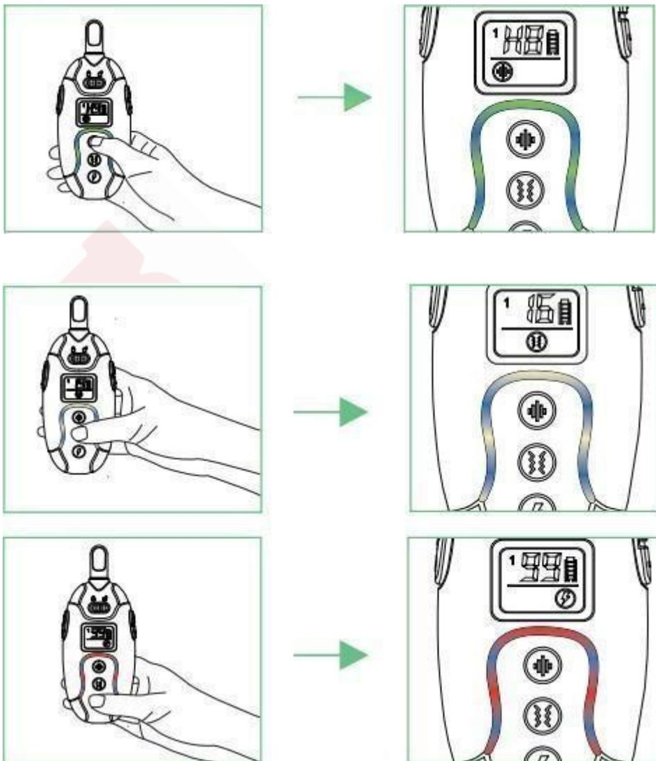
**Notiz:** Standardmäßig ist der Empfänger mit dem Fernbedienungssender in Kanal 1 gekoppelt. Wenn Sie einen neuen Empfänger kaufen, befolgen Sie bitte die obigen Kopplungsanweisungen, um ihn mit Kanal 2 zu koppeln. Das System kann bis zu 2 Empfänger auf 2 verschiedenen Kanälen koppeln. Wenn Sie Ihr Gerät nicht erfolgreich koppeln können, kann dies an Signalstörungen liegen. Bitte versuchen Sie es an einem anderen Standort oder kontaktieren Sie unser Service Center.
