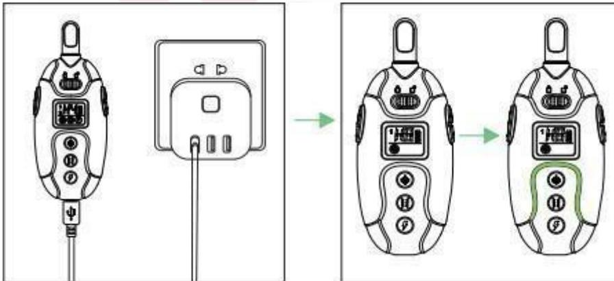
Empfänger - Laden Sie das Gerät auf, bis die Anzeige grün wird, was etwa 2-3 Stunden dauert.
