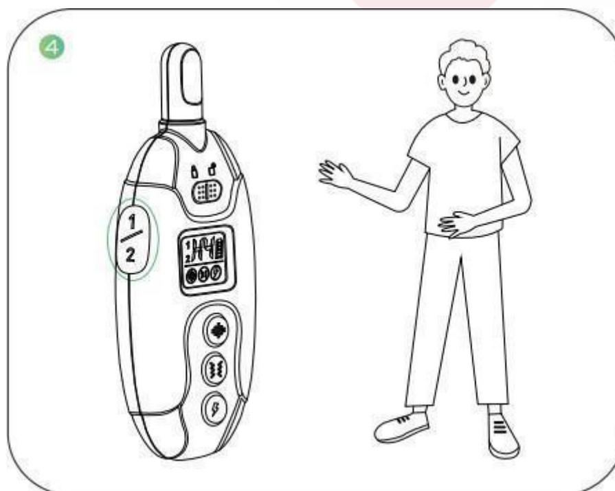
Um die Fernbedienung einzuschalten, halten Sie die Ein/Aus-Taste (Kanal) 2 Sekunden lang gedrückt.
