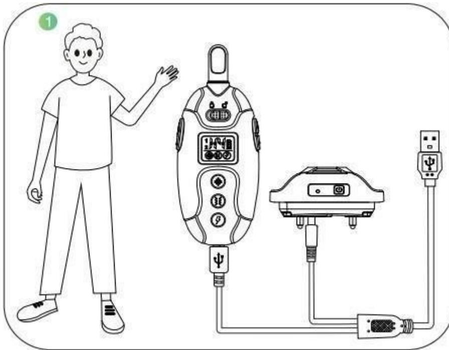
Laden Sie den Empfänger und die Fernbedienung 3 Stunden lang mit dem mitgelieferten USB-Kabel auf. Micro-USB wird verwendet, um den Fernsender aufzuladen, und 5,5 DC wird verwendet, um den Empfänger aufzuladen.
