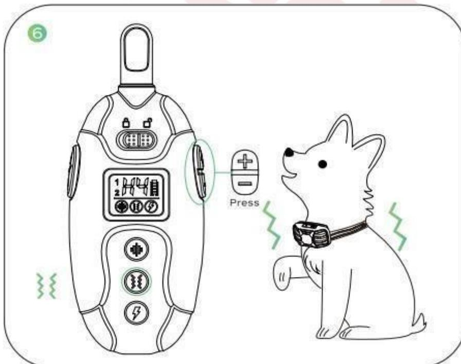
Vibration: Drücken Sie die Vibrationstaste, die gelben Lichter blinken schnell an beiden Enden und treffen sich in der Mitte, und der Empfänger beginnt zu vibrieren. Drücken Sie die Level-Taste, um die Vibrationsstufe einzustellen.
