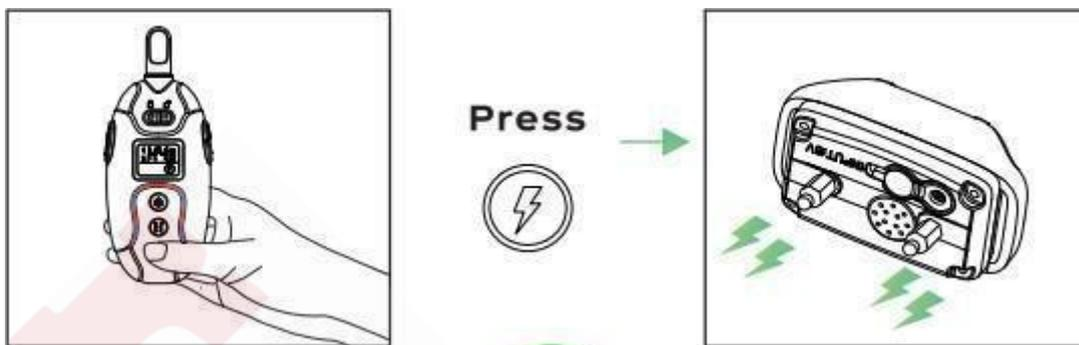
Kanalwechsel - Wenn Sie zwei Empfänger gekoppelt haben, drücken Sie die Kanaltaste und wählen Sie den Empfänger aus, den Sie steuern möchten.
