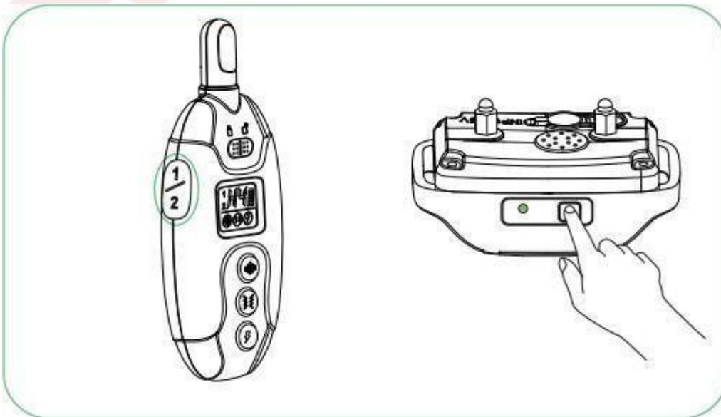
Drücken Sie dreimal die Ein/Aus-Taste am Empfänger, um in den Kopplungsmodus zu wechseln. Sie hören einen Piepton und die Anzeige leuchtet auf. Sie haben jetzt 10 Sekunden Zeit, um die Kopplung abzuschließen.
