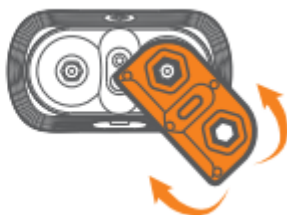
Inštalácia kontaktných bodov
