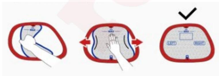
2. Presione y suelte suavemente; ambos lados se deslizarán automáticamente hacia la ranura. Asegúrese de que el borde azul esté completamente insertado en la ranura y que las flechas en ambos extremos estén alineadas. Un borde azul invisible indica una instalación exitosa.
