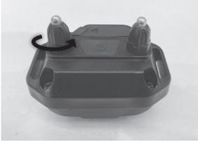
1. Schrauben Sie die Kontakte durch Drehen gegen den Uhrzeigersinn ab.
