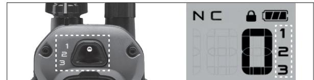
Wird ein zusätzlicher Empfänger hinzugefügt, können Sie mit dem Kippschalter vorne den gewünschten Empfänger auswählen. Die Nummer des gewählten Hundes wird auf dem Bildschirm angezeigt.
