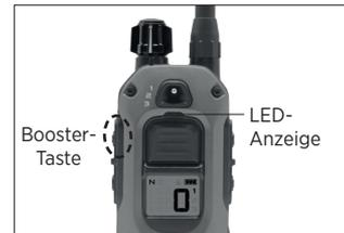
2. Halten Sie die Boostertaste 5 Sekunden lang gedrückt, bis die LED-Anzeige schnell blinkt; lassen Sie die Taste dann los.
