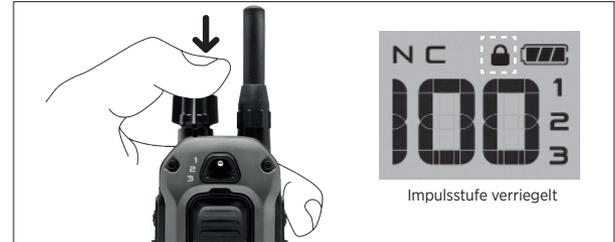
Um die Impulsstufe zu verriegeln, drücken Sie mehr als 2 Sekunden lang oben auf den Impulsstufenregler. Ein Schloss-Symbol auf dem Bildschirm zeigt an, dass die Impulsstufe verriegelt ist und nicht versehentlich verstellt werden kann. Um die Impulsstufe zu entriegeln, drücken Sie erneut 2 Sekunden lang oben auf den Impulsstufenregler.
