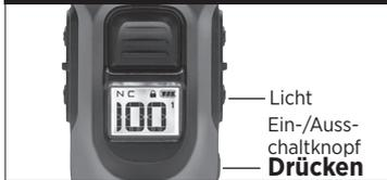
Halten Sie gleichzeitig die On-/Off-Taste und die Licht-Taste gedrückt.
