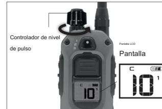
3. Gire el Control de nivel de pulso para seleccionar la intensidad del impulso que se agregará, que se muestra en la pantalla LCD.
