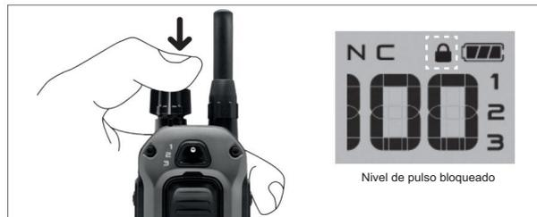
Para bloquear el nivel de pulso, presione la parte superior del control de nivel de pulso durante más de 2 segundos. Un símbolo de candado en la pantalla indica que el nivel de pulso está bloqueado y no se puede ajustar accidentalmente. Para desbloquearlo, presione la parte superior del control de pulso de nuevo durante 2 segundos.
