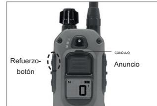
2. Mantenga presionado el botón de refuerzo durante 5 segundos hasta que el indicador LED parpadee rápidamente, luego suelte el botón.
