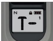
Biptón El receptor emite una señal de tono mientras se mantenga presionado el botón del transmisor, durante hasta 12 segundos.
