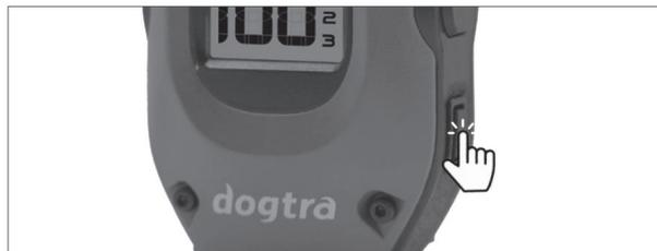
El botón de encendido del transmisor se encuentra en la parte inferior derecha. Presiónelo durante 2 segundos para encenderlo o apagarlo (púlselo brevemente para encender o apagar la retroiluminación de la pantalla).
