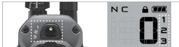
Si se añade un receptor adicional, puede seleccionar el receptor deseado con el interruptor frontal. El número del perro seleccionado se mostrará en la pantalla.
