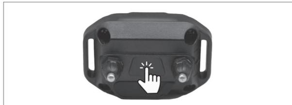
El botón de encendido del receptor se encuentra entre los contactos. Presione el botón durante 2 segundos para encenderlo o apagarlo. El indicador LED se ilumina en verde y suena un tono al encenderlo. Al apagarlo, también suena un tono y el indicador LED se ilumina en rojo.
