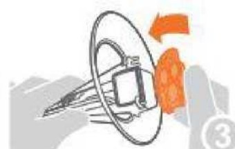
Kabel włóż w odpowiednia miejsca Zamknij pokrywę i dociśnij pompę
