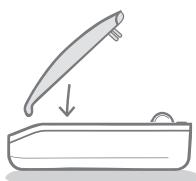
Um die Seitenschienen wieder einzusetzen, müssen Sie den Prozess in umgekehrter Reihenfolge wiederholen. Stellen Sie sicher, dass Sie sie erst an der Vorderseite und dann an der Hinterseite einhaken.
