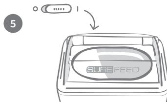
Platzieren Sie die Futterschale an der **gewünschten Stelle** und schalten Sie es dann ein. Dies ist erforderlich, damit die Sensoren korrekt kalibriert werden können.
