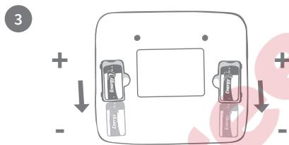
Legen Sie die Batterien ein. Achten Sie darauf, dass die (+/-)-Symbole auf den Batterien entsprechend der Symbole auf dem Gerät eingesetzt werden.
