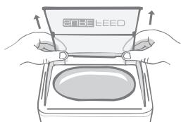
Entfernen Sie zuerst die Abdeckung der Futterschale. Drücken Sie die manuelle Öffnen/Schließen-Taste und, sobald die Abdeckung geöffnet ist, ziehen Sie diese nach oben.
