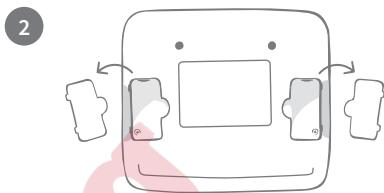
Entfernen Sie die Batteriefachdeckel.
