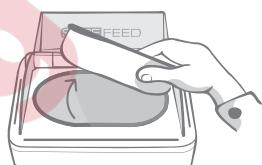
Drücken Sie die manuelle Öffnen/Schließen-Taste (▲), um sicherzustellen, dass die Abdeckung sich öffnet und geöffnet bleibt. Die weiße LED leuchtet auf.
