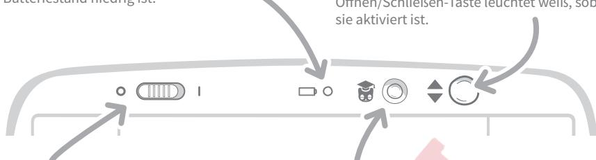
Wenn Sie den **Einschaltknopf** nach rechts schieben, ist das Gerät eingeschaltet, wenn Sie ihn nach links schieben, ist es ausgeschaltet. Die Abdeckung wird geschlossen, sobald das Produkt ausgeschaltet wird.
