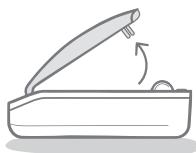
Halten Sie eine der Seitenschienen nahe der Rückseite und ziehen Sie sie nach oben, bis es Ihnen möglich ist, das Vorderteil auszuhaken. Dafür ist ein kräftiges Ziehen erforderlich. Wiederholen Sie diesen Schritt für die zweite Seitenschiene.
