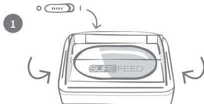
Nachdem Sie sichergestellt haben, dass das Gerät ausgeschaltet ist, drehen Sie es zum Öffnen der Batteriefächer um.
