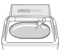
Geben Sie Futter in eine frische Futterschale. Achten Sie darauf, dass Sie die Schale **nicht überfüllen**, da sonst der Schließmechanismus der Abdeckung beeinträchtigt wird und Verunreinigungen entstehen können.
