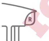
Die Seitenschienen sind an der Rückseite mit einem kleinen L (links) beziehungsweise einem R (rechts) markiert, um anzudeuten, auf welcher Seite die beiden Seitenschienen wieder angebracht werden müssen. Stellen Sie sicher, dass Sie die Seitenschienen auf der jeweils richtigen Seite wieder anbringen.
