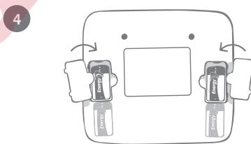
Setzen Sie die Batteriefachdeckel wieder ein.
