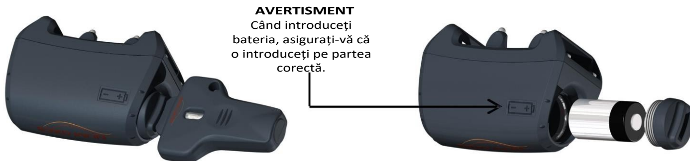
Diagrama 4 Introducerea bateriei în receptorul CANICOM 5
